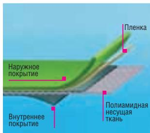
Высокопрочный многослойный материал VAUTEX SL: замечательные химические свойства при одновременном уменьшении веса и значительном повышении гибкости материала.
