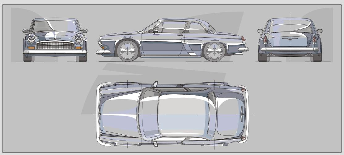
**Габаритные размеры:** длина - 4806 мм ширина - 1998 мм высота - 1378 мм
