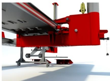
^ Визуализация нового стапеля для правки кузовов - разработки компании Евро-СИВ-Импорт
