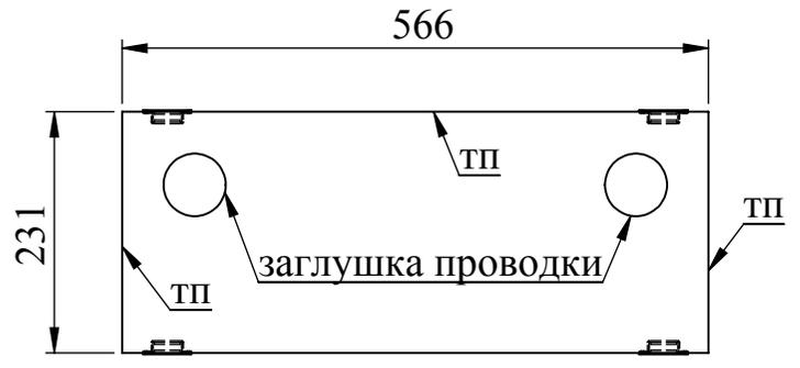
**съемная задняя стенка на магнитах (деталь 31)**
