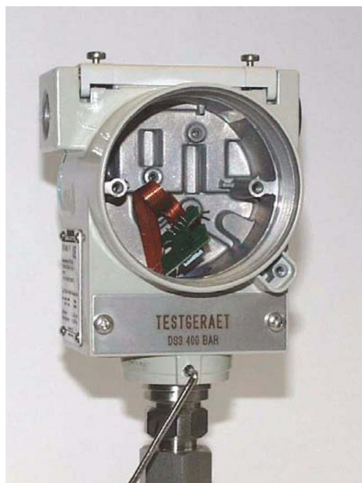
Рисунок 28 Отпустить стопорные винты с помощью ключа
