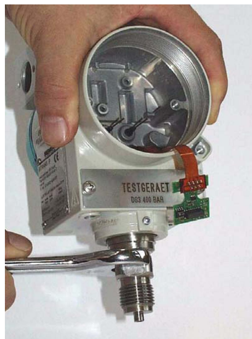
Рисунок 29 Открутить ячейку с помощью рожкового ключа
