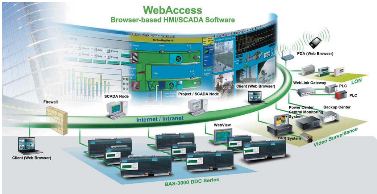
Рис. 1. Архитектура системы автоматизации с ПО WebAccess
