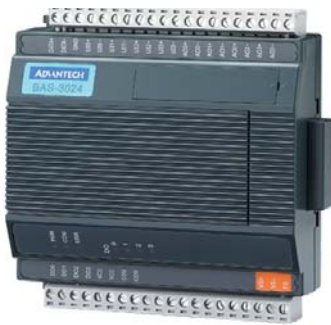
● Рис. 3. Модуль ввода/вывода BAS-3024
