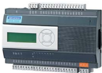
● Рис. 2. Программируемый контроллер BAS-3520
