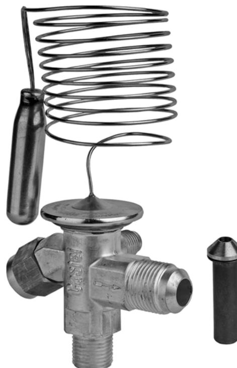
Термозлемент — это привод клапана; термобаллон соединен с диафрагмой термозлемента через капиллярную трубку длиной 1,5 м, посредством которой передается изменение давления внутри термобаллона на диафрагму клапана. Давление внутри термобаллона зависит от температуры хладагента.
