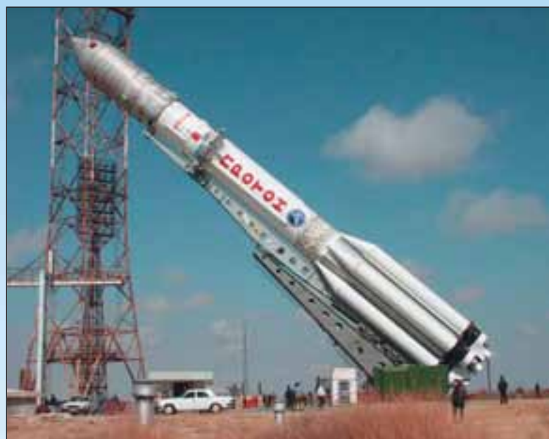
Гидравлический установщик с ракетой-носителем «Протон». Установка ракеты на стартовое сооружение
