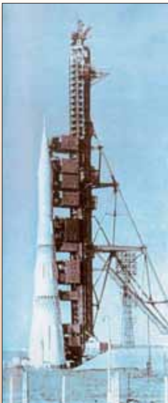
Подготовка к пуску ракеты-носителя Н-1 с лунным комплексом Л3 на стартовой позиции космодрома Байконур
