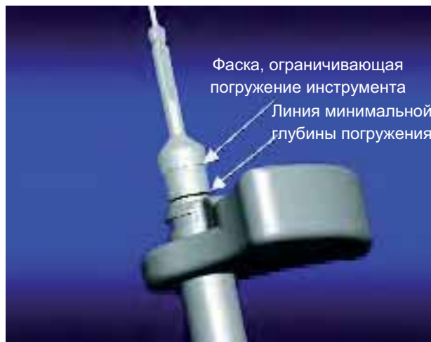
Иллюстрация 17: Метки глубины погружения приспособления для зенкования отверстия
