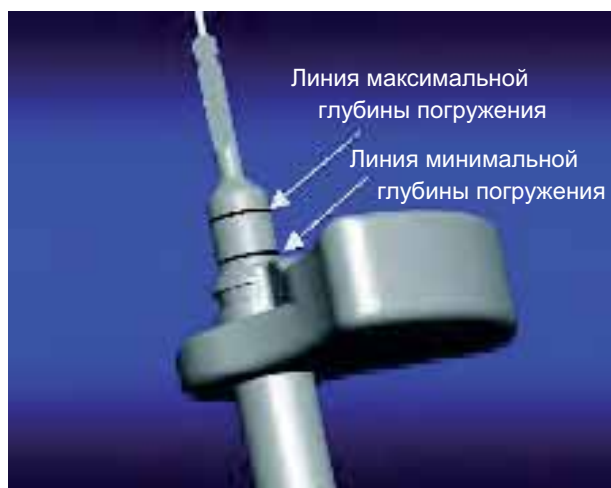
Иллюстрация 15: Метки глубины погружения
