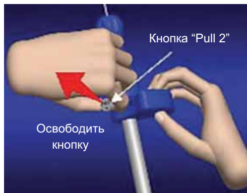
Иллюстрация 9: Освобождаем (оттягиваем на себя) кнопку "Pull 2"
