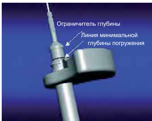
Иллюстрация 13: Приспособление для предварительного сверления. Ограничитель глубины погружения
