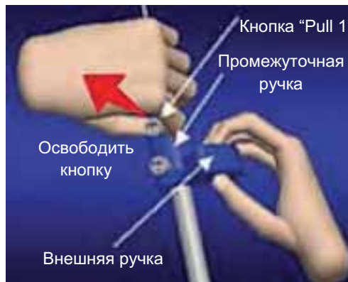
Иллюстрация 7: Освобождаем (оттягиваем на себя) кнопку "Pull 1"
