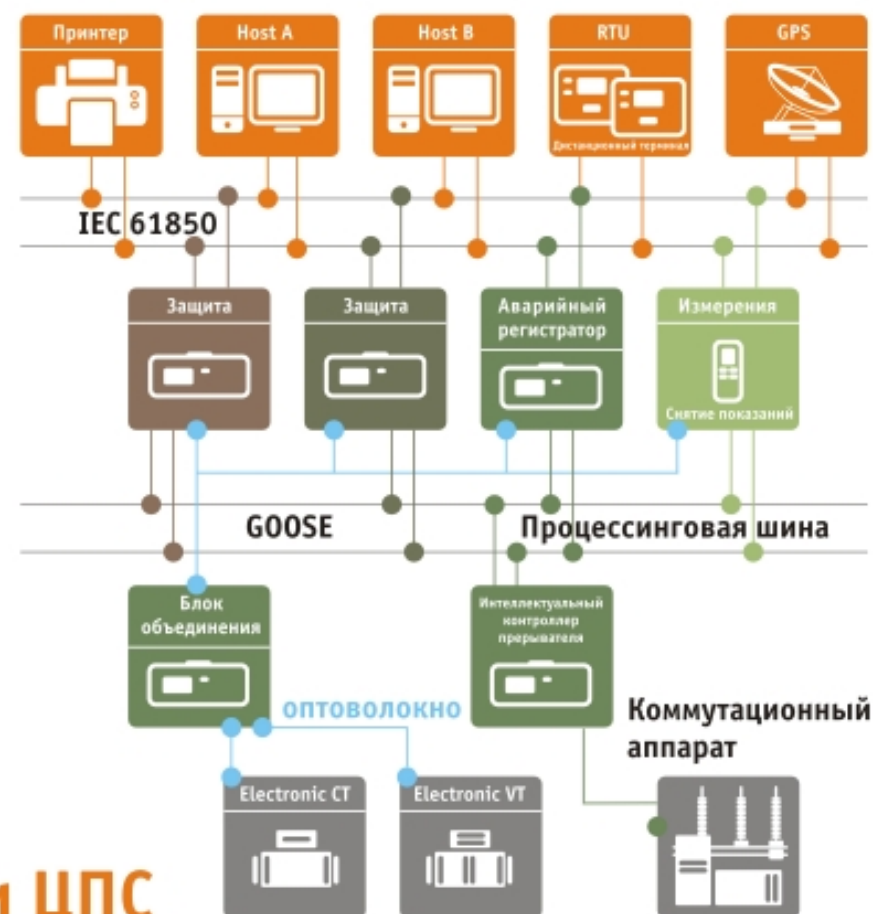
Цифровая (SMART) подстанция
