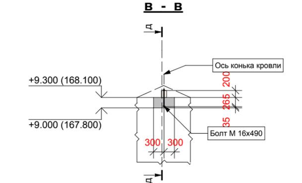
Бетонный вкладыш 300x600x300 из бетона класса В 15 с анкерными болтами для крепления конькового бруса кровли
