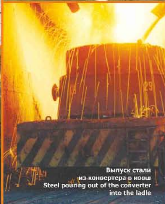
Сталевоз СС-160-3600 под установкой внепечной обработки Teeming ladle car СС-160-3600 under ladle metallurgy facility
