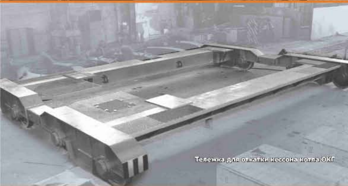
Тележка передаточная грузоподъемностью 120 т Transfer car of 120-t load carrying capacity
