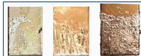
Рис. 4. Образцы из нержавеющей стали AISI 304. Следы смачивания есть на всех образцах
