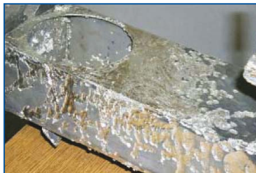
Рис. 1. Повреждение канала подачи припоя из нержавеющей стали
