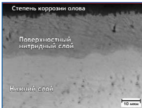
Рис. 6. 100-кратное изображение образца из нержавеющей стали AISI 304 с покрытием Melonite®, полученное с помощью оптического микроскопа
