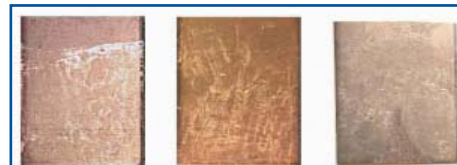
Рис. 5. Образцы из нержавеющей стали AISI 304 с покрытием Melonite®. Следы смачивания видны только на образце, который соответствует 8-й неделе, у царапины
