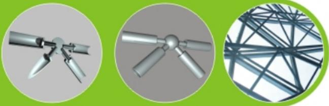
SpaceStructure - шарово-стержневая строительная каркасная система. Пространственные строительные конструкции на базе технологии SpaceStructure являются самонесущими, выдерживают огромные нагрузки, позволяют перекрывать большие пространства, такие как:
