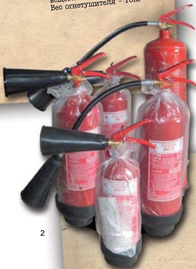
*Углекислотные огнетушители – это газовые огнетушители, в которых в качестве газа используется углекислота.*
