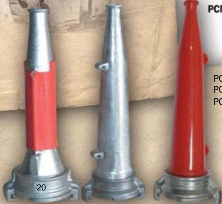
Стволы пожарные ручные СРК-50, РСР-50, РСР-70, РСРЗ-70 ДСТУ 2112-92 (ГОСТ 9923-93) предназначены для формирования и направления сплошной и распыленной струи воды или раствора смачивателя, а также для перекрытия потока, а ствол РСРЗ-70 - также и для образования защитной водяной завесы, предохраняющей ствольщика от тепловой радиации.
