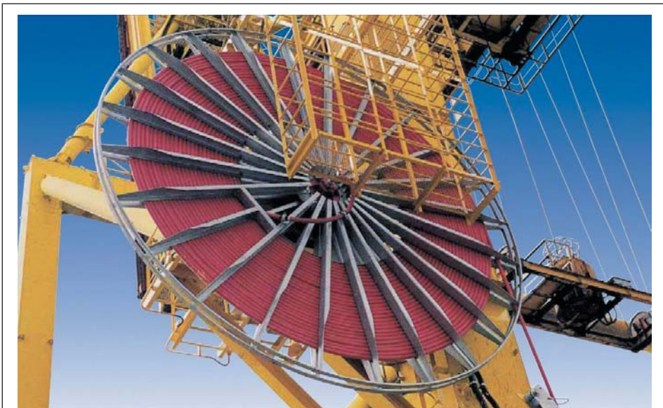
Рис. 11. Кабельные барабаны с электроприводом
